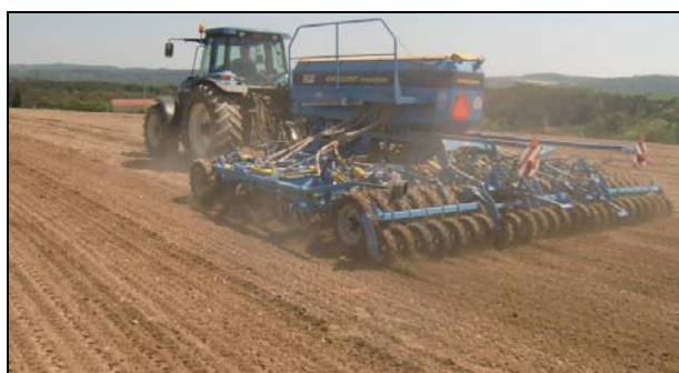
Secí stroj Farmet EXCELENT Premium nabízí výbornou kvalitu setí a vysokou produktivitu. Urovná povrch, zpětně utuží půdu a obnoví kapilaritu, vytvoří seťové lůžko a zajišťí přesnou hloubku setí.
