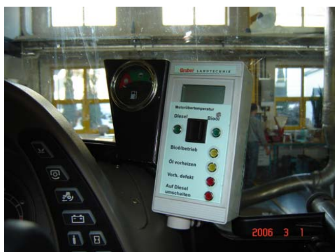
Obr.3 Ovládací a informační panel použitý u dvou-palivového systému traktoru Case IH 135 MXU
