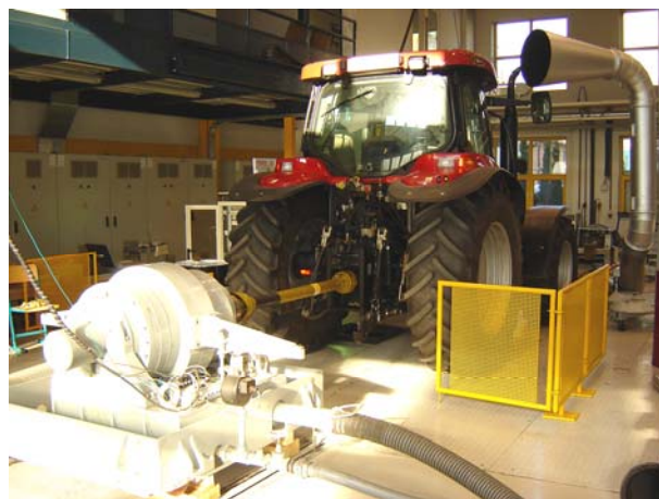
Obr.1 Měření výkonu motoru traktoru Case IH 135 MXU přes vývodový hřídel [1]
